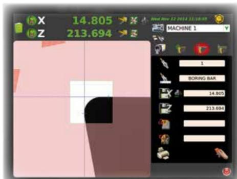
Nouvelle base électronique : l'utilisation d'un pc intégré sans ventilation de refroidissement, fonctionnant sous linux, permet une gestion facilitée des fonctions de mesures, de stockage des informations outils et de la mise en route des différentes jauges et origines machines via le grand écran tactile.
