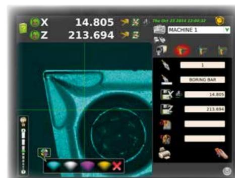
Inspection des outils pour contrôler l'état des arrêtes de coupe. Possibilité de modifier la luminosité pour une meilleure analyse de l'outil.
