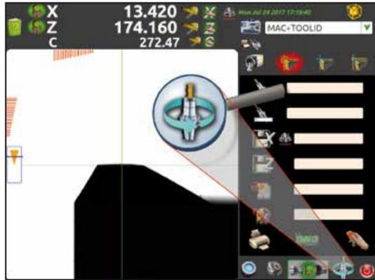
*Fonction **Autofocus**: le tout nouveau mode de fonctionnement, permet au banc de mesurer automatiquement les outils sans la manipulation de l'opérateur.*
