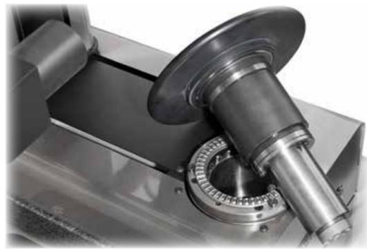
Broche interchangeable avec blocage mécanique, montage par deux roulements à billes précontraints, permettant une concentricité précise et durable.
