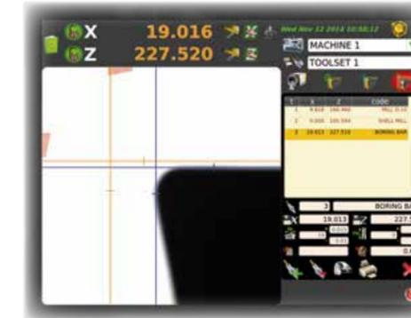
Td SIX est un nouveau logiciel développé par ELBO CONTROLLI, utilisé pour acquérir les mesures des outils, pour écrire dans les tables d'outils et créer des fichiers incluant les correcteurs d'outils.
