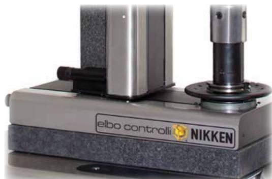
Granit naturel employé tant pour la colonne que pour l'embase. La stabilité thermique du matériau permet d'utiliser la machine directement dans l'atelier. Acier inoxydable employé pour la mécanique.
