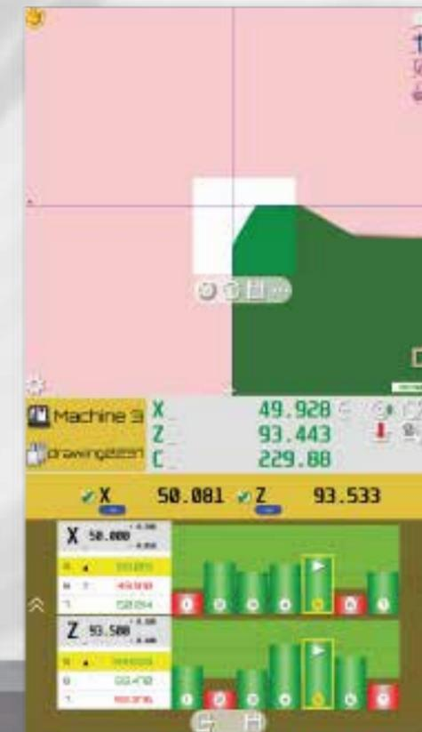
Elbo Controlli NIKKEN ha sviluppato un sistema che adatta la velocità periferica di rotazione dell'utensile in base al diametro massimo da misurare: la velocità periferica costante evita l'introduzione di errori, sia che si stia misurando un utensile di diametro 2 mm che uno da 200 mm.
